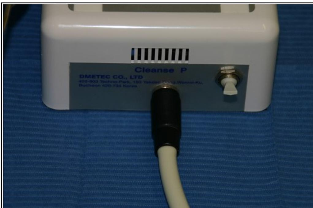
**Drehen Sie die Schraubverbindung mit der Hand zu**
