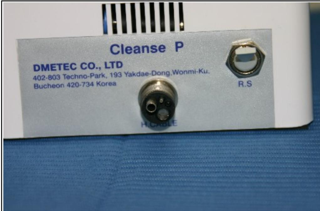
**Stecken Sie den Turbinenschlauch auf die Kupplung am Cleanse P**
